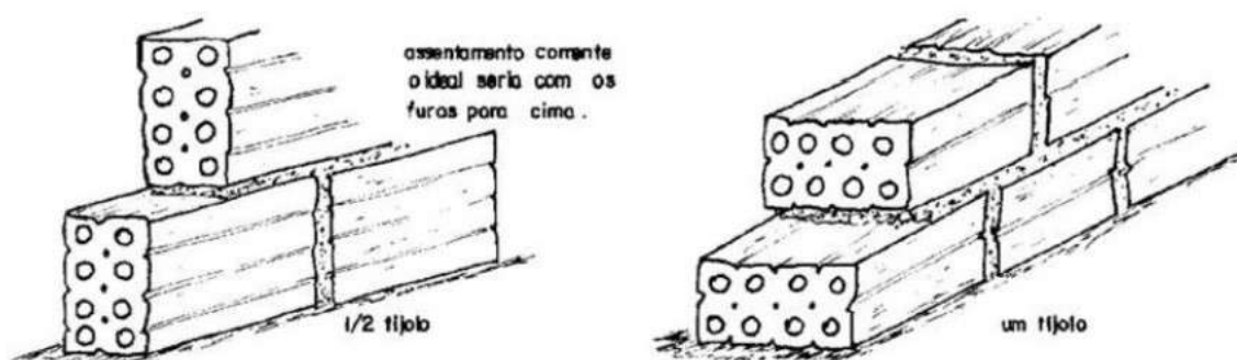
Figura 1 - Execução de alvenaria utilizando tijolos furados
